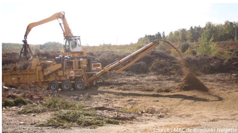
Source : MRC de Rimouski-Neigette Broyage des branches récupérées à l'écocentre en copeaux en vue de leur valorisation au site de compostage
